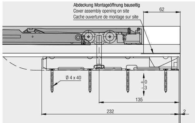
Hawa Porta 100 HMT Pocket: Für Montage und Demontage Push-to-open stirnseitigen Zugang gewährleisten
