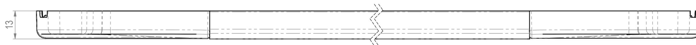
Tiefenposition der Schublade muss mit der Frontabdeckung hinter Türen um min. 7mm erhöht werden
